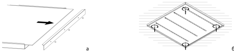
Рисунок 11 — Накладной монтаж светильника Geniled серии Офис, ЛПО.
